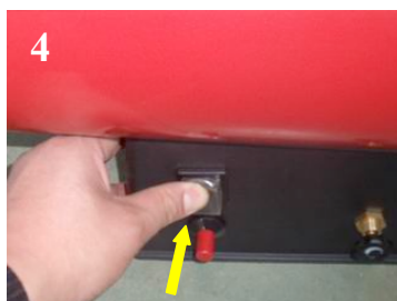
Aseta virtakytkin päälle asentoon "I"
