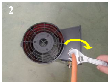
Kiristä liittimen mutteri nuolen osoittamaan suuntaan
