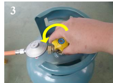
Avaa kaasupullon venttiili nuolen osoittamaan suuntaan
