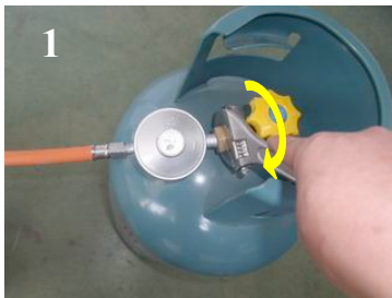
Kiristä liittimen mutteri nuolen osoittamaan suuntaan
